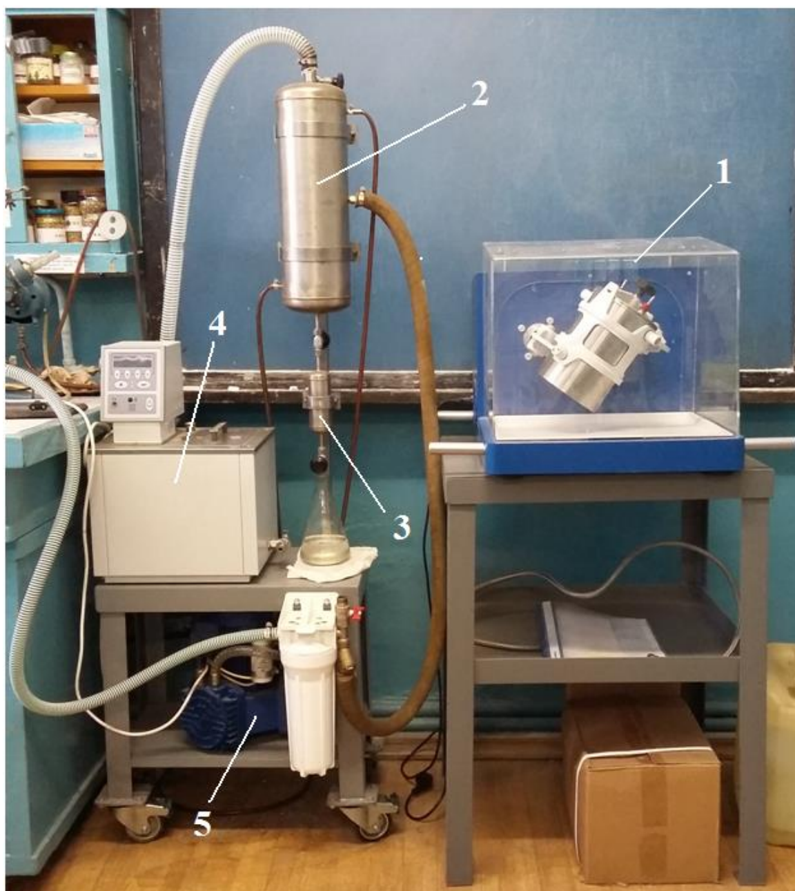
Рисунок 23 – Лабораторная установка для синтеза Ru-содержащих катализаторов на основе СПС марок MN 270 и MN 100: 1 – смеситель «Турбула»; 2 – холодильник; 3 – пробоотборник; 4 – термостат; 5 – вакуум-насос
