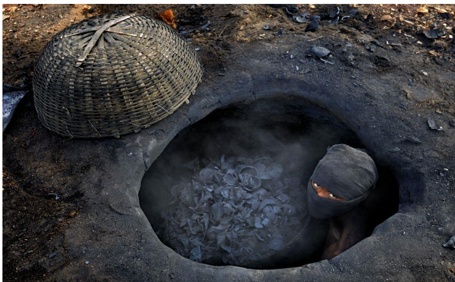
Рисунок 26 - Один из широко практикуемых примитивных способов кустарного производства угля из СКО
