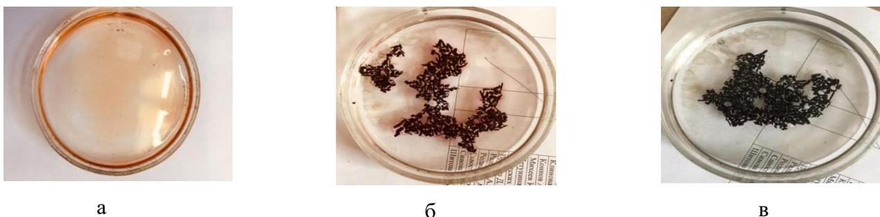
Рисунок 6 - Развитие процесса фиксации плёнки ДТ толщиной 1,4 мм порошком фракции 1-2 мм активного угля паровой активации на базе ЖД дозой  $2,8 \cdot 10^{-2}$  г/см<sup>2</sup>: длительность контакта фаз (мин): 0 (а), 1 (б) и 30 (в)
