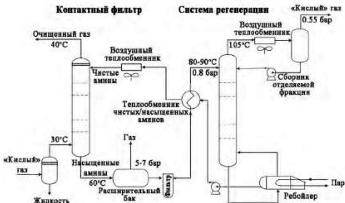
Рисунок 1.5 — Схема установки традиционной аминовой очистки газа
